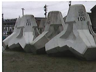
波消ブロック
